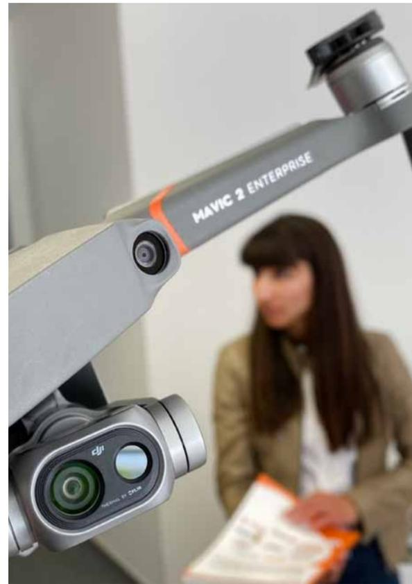
Im Bild zu sehen: eine Drohne mit Infrarot- und Wärmebildkamera ausgestattet, eine schnellere Rettung der Patienten ermöglicht.
